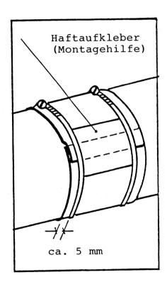
Dichtungsmanschette mit der Alukaschierung nach außen überlappend um die abzudichtende Stelle legen.
